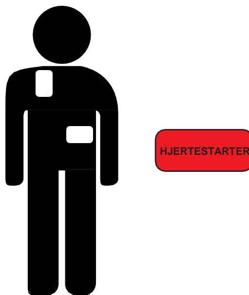
Figur 6: Korrekt påsatte elektroder
